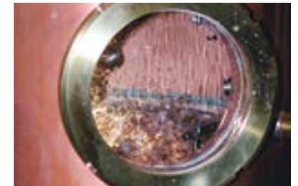
Das Destillat köchelt auf einem Boden in der Verstärkerkolonne.
