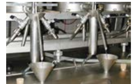
Im Kühler kondensieren die Alkoholdämpfe und rinnen als klares flüssiges Destillat heraus.
