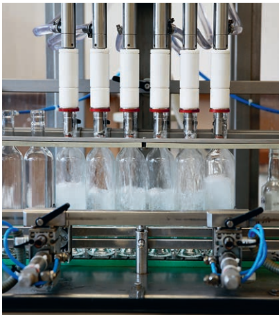
Am Schluss wird er auf 40 bis 50%Vol. rückverdünnt und in Flaschen abgefüllt.
