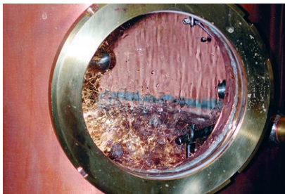
Das Destillat köchelt auf einem Boden in der Verstärkerkolonne.
